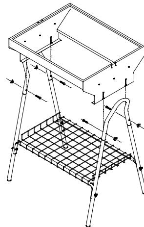
Montar las columnas (G) con 2 tornillos (R) y 2 tuercas (Q).
